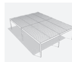
mehrfach freistehend mit Zwischenquerträgern
