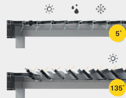
Position und Wirkungsweise der Lamellen
