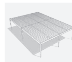
multiple, autoportante avec traverses intermédiaires
