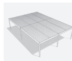
multiple, autoportante avec traverses intermédiaires
