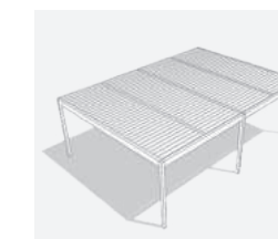
multiple, autoportante avec traverses intermédiaires
