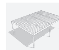
doppia autoportante con traversi intermedi
